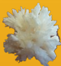
Exemple d'échantillon polycristallin qu'il ne faut pas obtenir
