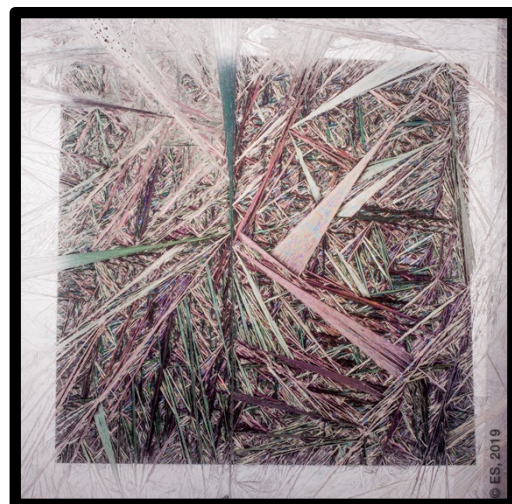
Exemple de tableau polycristallin en couche mince pour l'observation des différentes facettes en lumière polarisée.
